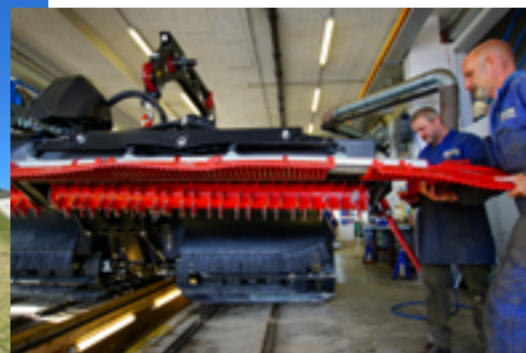
Gerhard Mariacher und Ernst Brennsteiner vom Werkstatt-Team bei der Reparatur der Schneefräse eines Pistengerätes.
